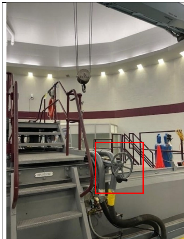
Figure 3. Photo montrant le volant de manœuvre servant à déplacer le pont du réacteur. Les élingues jaunes de la grue sont restées coincées sur le volant de manœuvre alors que la grue montait.
