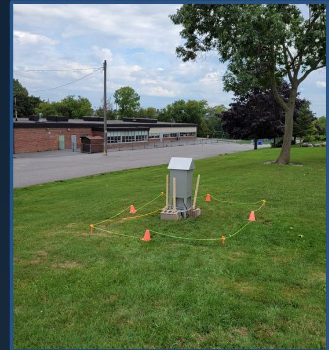
Échantillonneur d'air aux fins d'échantillonnage prolongé à l'école locale adjacente à BWXT NEC Peterborough
