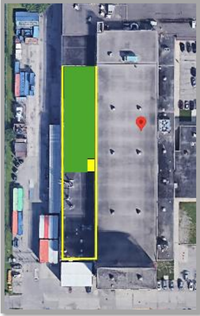
Figure 1 ci-dessus : carré jaune indiquant l'emplacement de l'incendie sur le toit; la partie verte indique la section du toit ayant déjà été réparée; le reste de la zone à l'intérieur de l'encadré jaune correspond à la partie du toit où les travaux de réparation n'ont pas encore débuté
