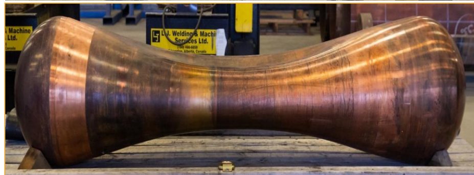
Système de barrières techniques de la SGDN – Épreuve de pression externe de l'UFC (gracieuseté de la SGDN)
