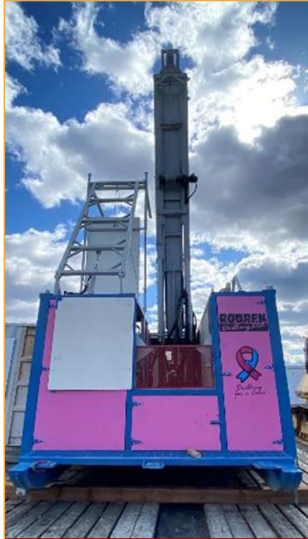
Caractérisation du site de la SGDN – Appareil de forage et de carottage (gracieuseté de la SGDN)
