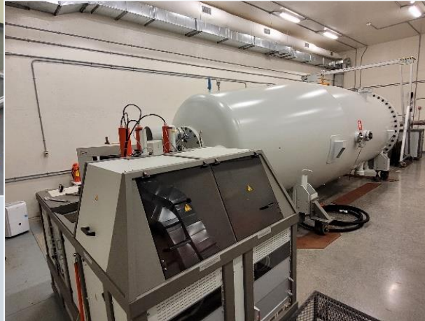
Un tandetron, type d'accélérateur de particules à haute tension
