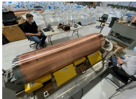
Examens non destructifs des CCU (gracieuseté de la SGDN)
