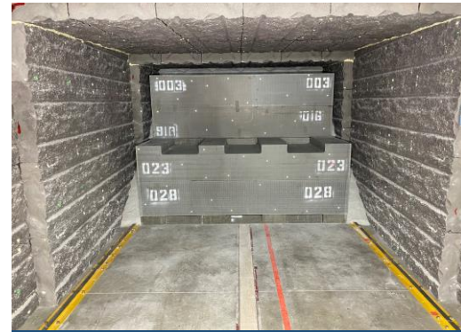
Stockage des composants du SBA dans un modèle de salle souterraine à pleine échelle (gracieuseté de la SGD N)
