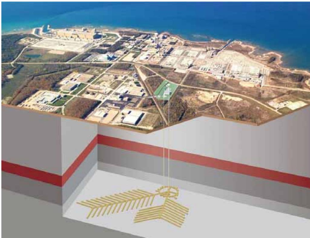
**Figure K.1** — Concept de dépôt en couches géologiques profondes
