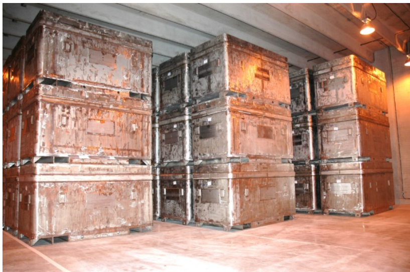
Figure H.2 : Conteneurs de déchets de retubage des tranches 1 et 2 de Bruce actuellement stockés dans le bâtiment de stockage des composants de retubage de l'IDGW d'OPG
