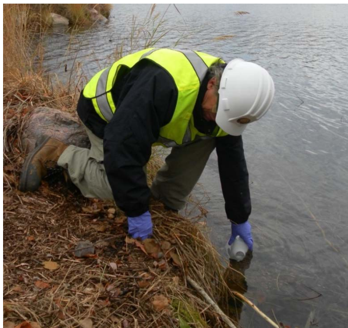
Figure F.1 : Surveillance des effluents
