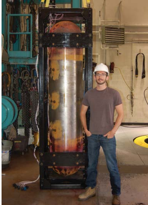
Figure K.4 : Un employé de la SGDN pose avec un prototype de conteneur de combustible usé à l'installation d'essai de haute pression de l'Applied Research Laboratory à l'Université de l'État de Pennsylvanie
