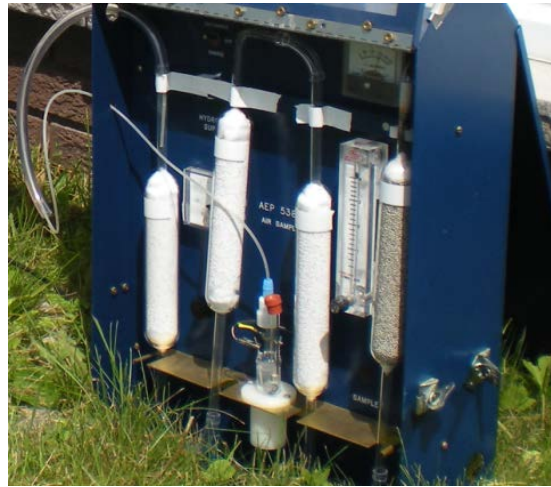
Figure 5 : Un échantillonneur d'air actif pour le tritium doté de tamis moléculaires des Laboratoires Nucléaires Canadiens (anciennement Énergie atomique du Canada limitée) [29]
