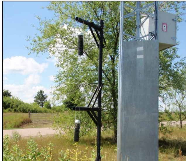
Figure 4 : Échantillonneur passif pour le tritium dans l'air sur le site d'une installation de traitement du tritium [28]
