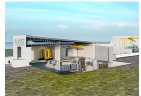
Exemple de la technologie des PRM : Réacteur intégral à sels fondus de Terrestrial Energy (Illustration : Terrestrial Energy)
