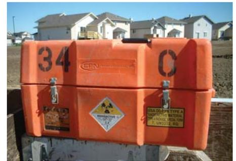
Un radiamètre est également requis afin de vérifier que l'intensité du rayonnement à proximité du colis, étiqueté de manière adéquate, est sécuritaire et conforme aux exigences réglementaires de la CCSN.
