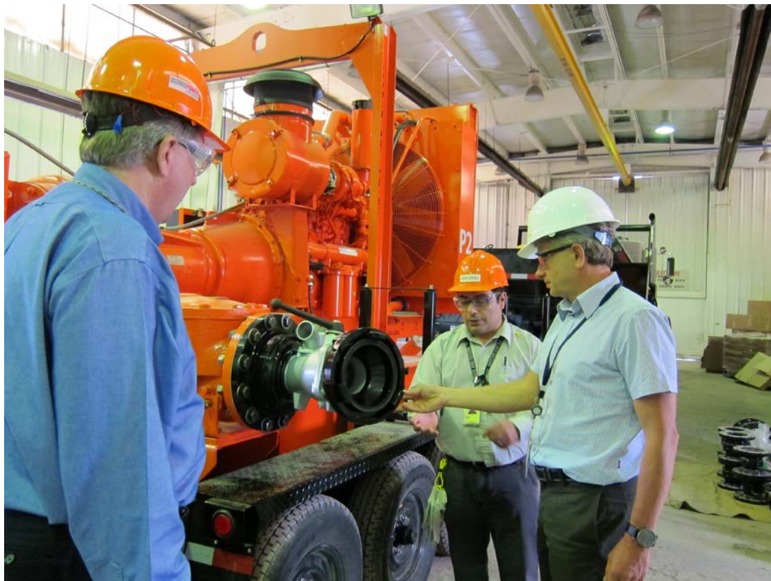
Figure 2.4 : Une pompe portable d'urgence, un des appareils d'atténuation des situations d'urgences
