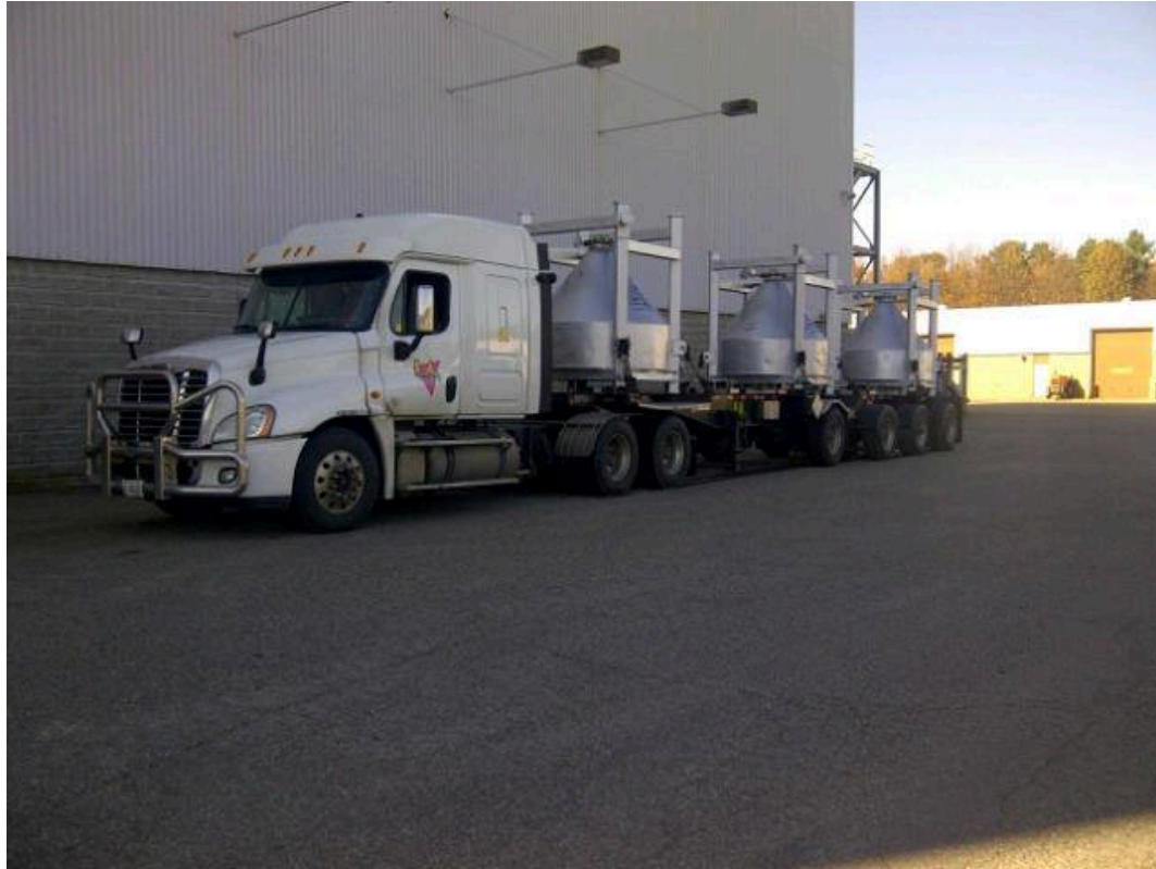
Figure 3-2 : Récipients d'expédition utilisés pour le transfert de l'UO 3 de la raffinerie de Blind River à l'installation de conversion de Port Hope
