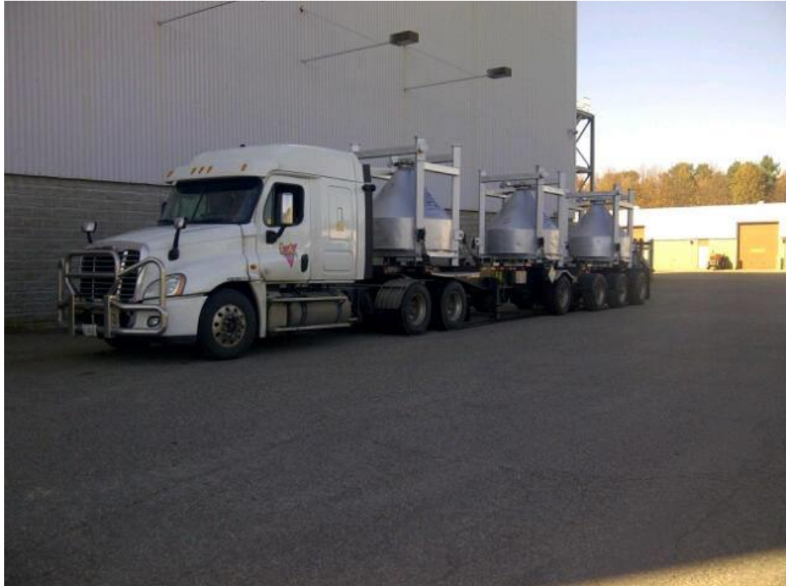
Figure 3-2 : Récipients de transport utilisés pour le transfert de l'UO 3 de la RBR à l'ICPH
