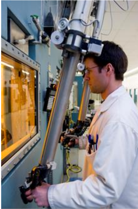
Figure 9-2 : Un travailleur de Nordion utilisant un manipulateur de cellule chaude
