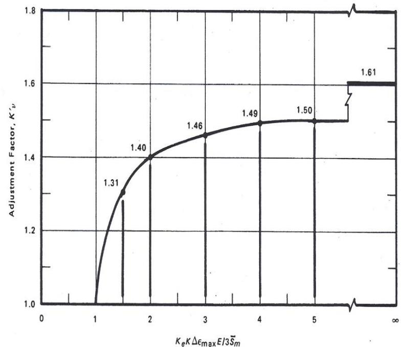
FIG. T-1432-3 ADJUSTMENT FOR INELASTIC BIAXIAL POISSON'S RATIO
