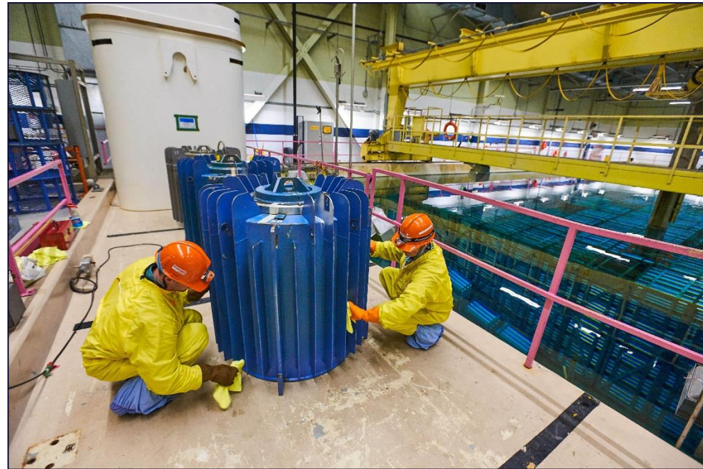
Source : opg.com - La centrale nucléaire de Pickering expédie des châteaux d'isotopes de cobalt 60
