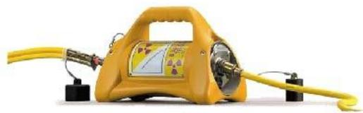
**Image 6 : Inspection non destructive de pipeline au moyen d'un appareil de gammagraphie industrielle**
