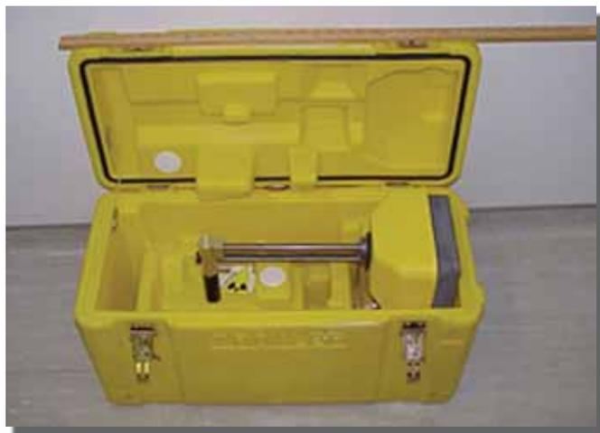
**Figure 7.** Jauge nucléaire portative de type Troxler dont la source (de type « crayon ») est en position blindée
