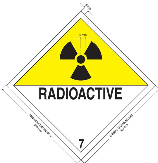
Selon le *Règlement sur le transport des marchandises dangereuses*, une plaque de classe 7 doit être apposée sur chacun des quatre côtés d'un véhicule, dans les cas suivants :
