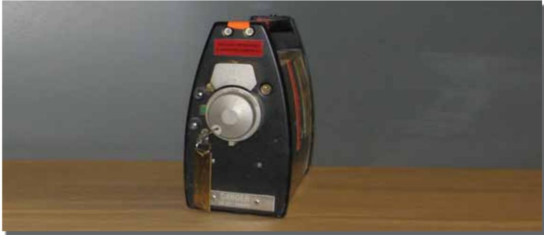
**Figure 30.** Appareil d'exposition Sentinel 660B avec suremballage OPL 660
