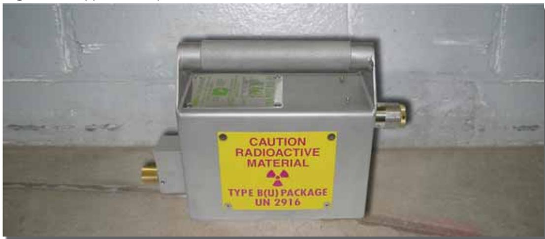
**Figure 37.** Source étalon contenue dans un appareil d'exposition; la source radioactive se trouve dans le bout de l'appareil, près du doigt, sur la photographie; si vous voyez une telle source, n'y touchez pas et reculez immédiatement de 400 m; reportez vous au tableau 1 de l'annexe pour déterminer le débit de dose gamma
