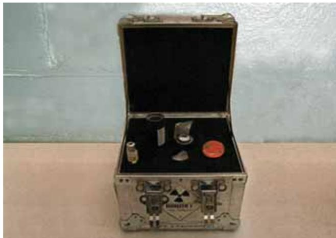
**Figure 23.** Vue intérieure du colis de la figure 22. Note : le « saumon de plomb » cylindrique contient habituellement un flacon dont l'étiquette indique « Tc-99m » ou un autre liquide radioactif utilisé en médecine nucléaire. Le flacon ne porte aucune étiquette puisqu'il est utilisé à des fins d'enseignement. Il est seulement rempli d'eau.
