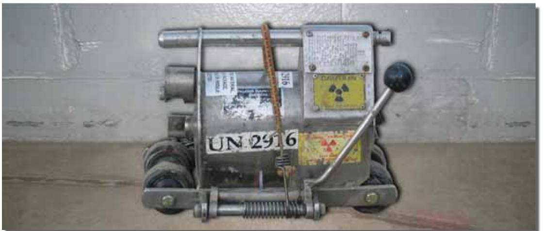
**Figure 35.** Appareil d'exposition Gammamat TSI5
