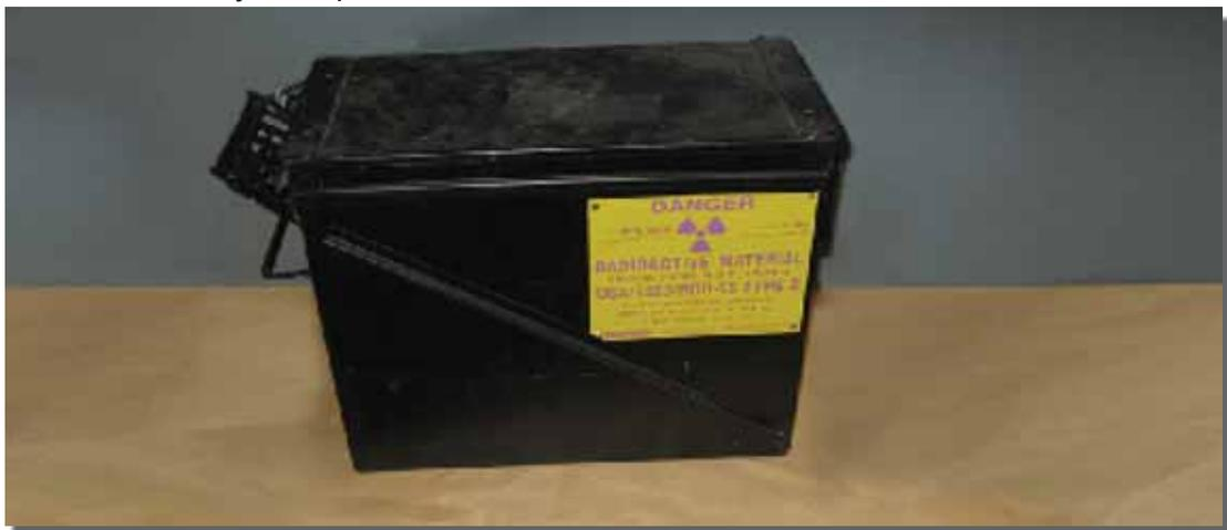
**Figure 32.** Appareil d'exposition Sentinel 880
