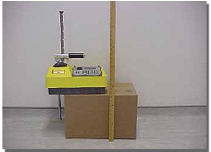
**Figure 9.** Jauge nucléaire portative de type Humboldt dont la source (de type « crayon ») est en position blindée
