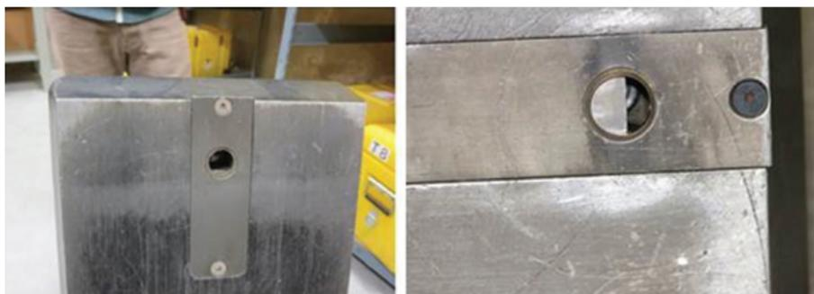
Exemple d'un obturbateur complètement ouvert (à gauche) et d'un autre à moitié fermé (à droite)
