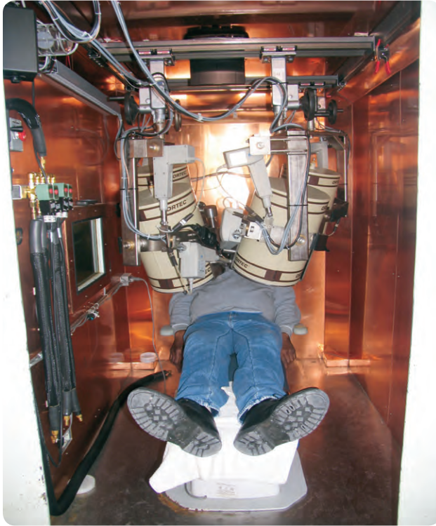
FIGURE 11. Compteur pulmonaire classique. Cet appareil est utilisé par le Bureau de la radioprotection de Santé Canada, à Ottawa.
