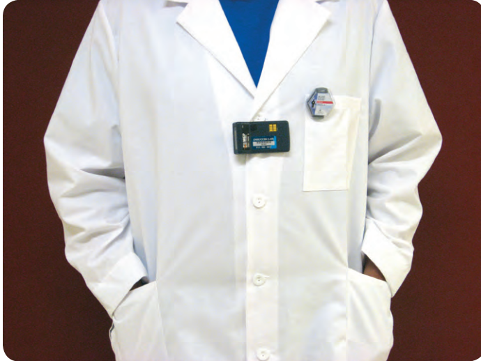
FIGURE 7. Dosimètre à lecture directe et dosimètre à luminescence stimulée optiquement, portés à l'avant du torse.
