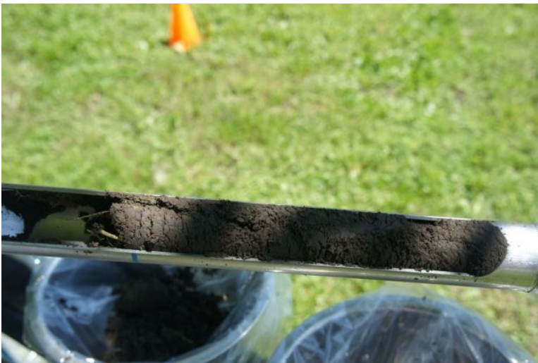
Figure 3. Échantillon de sol prélevé par un employé du MEO au moyen d'un carottier
