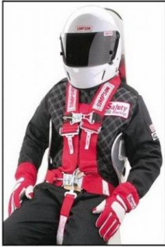
Figure 1 : Exemple de harnais de course à ancrages multiples
