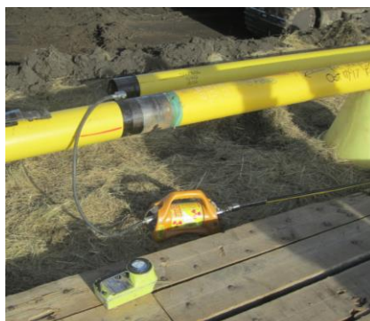
Figure 28 : Appareil d'exposition utilisé pour l'essai non destructif des matériaux (Source : CCSN)
