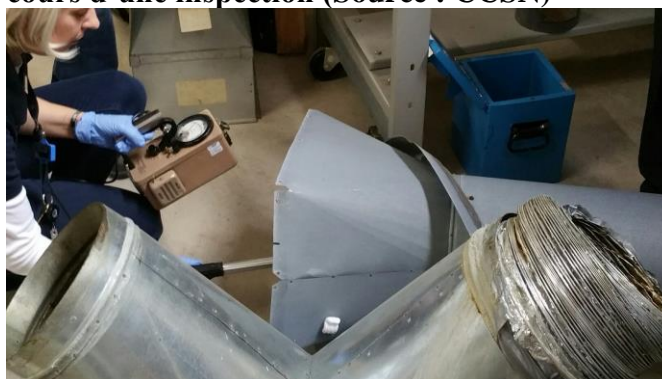
Figure 8 : Vérification de la contamination au cours d'une inspection (Source : CCSN)
