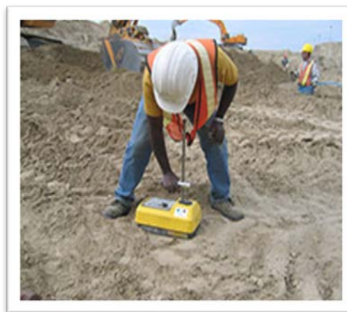
Figure 6 : Travailleur utilisant une jauge portative pendant des travaux de construction
