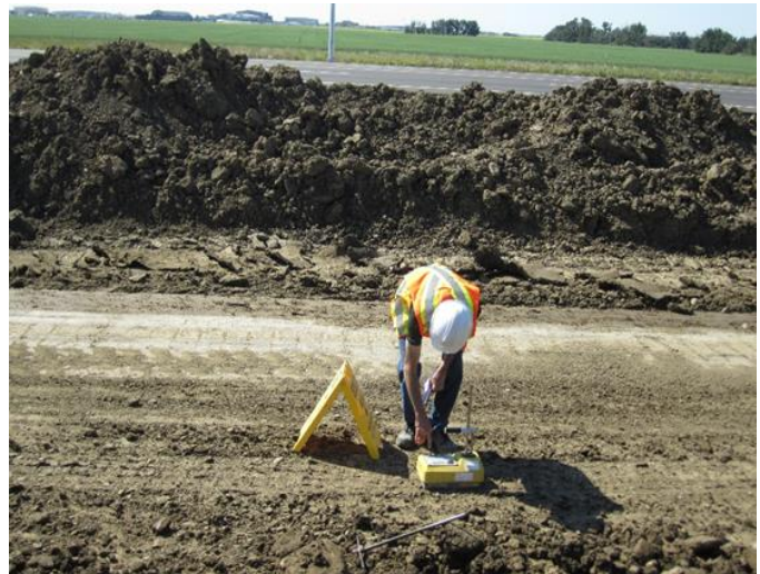
Utilisateur d'une jauge portative mesurant les propriétés du sol
