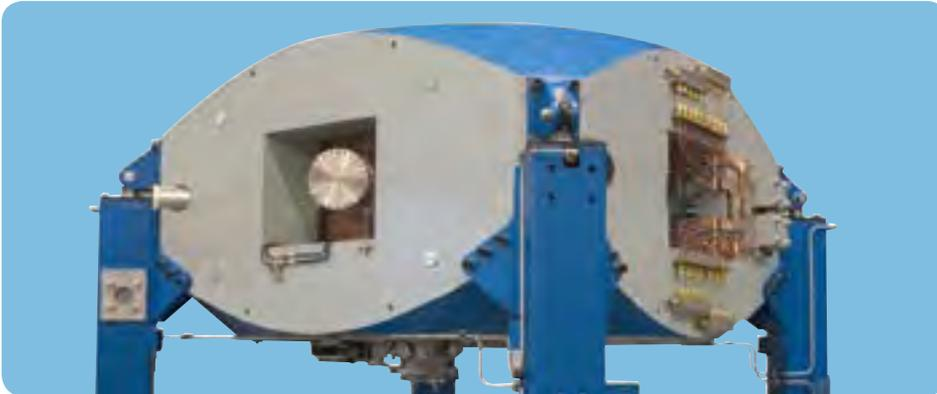
Les cyclotrons TR sont des cyclotrons à ions négatifs qui permettent de produire des radio-isotopes pour la communauté biomédicale de façon rapide et fiable ainsi que d'obtenir un rendement élevé.
