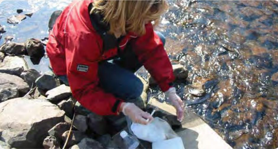
*Une inspectrice de la CCSN mesure la qualité de l'eau dans une zone de gestion des résidus d'une mine décontaminée à Elliot Lake (Ontario) pour s'assurer que les critères relatifs aux effluents respectent les normes de rejet fixées en vertu des permis de la CCSN.*
