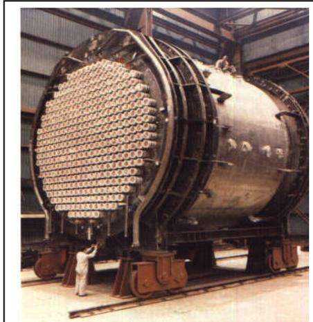
Photo d'un travailleur à proximité de la calandre détachée d'un réacteur CANDU.
