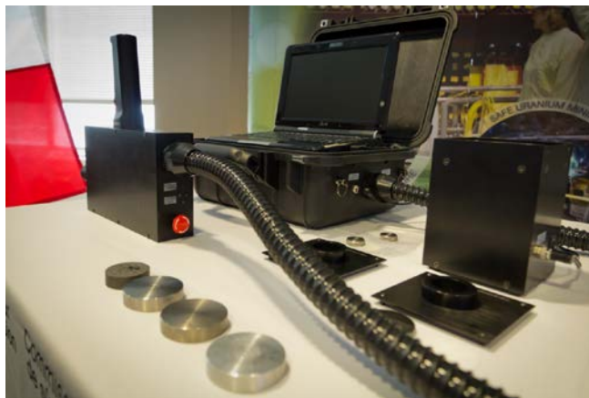
Un appareil portable de spectroscopie sur plasma induit par laser
