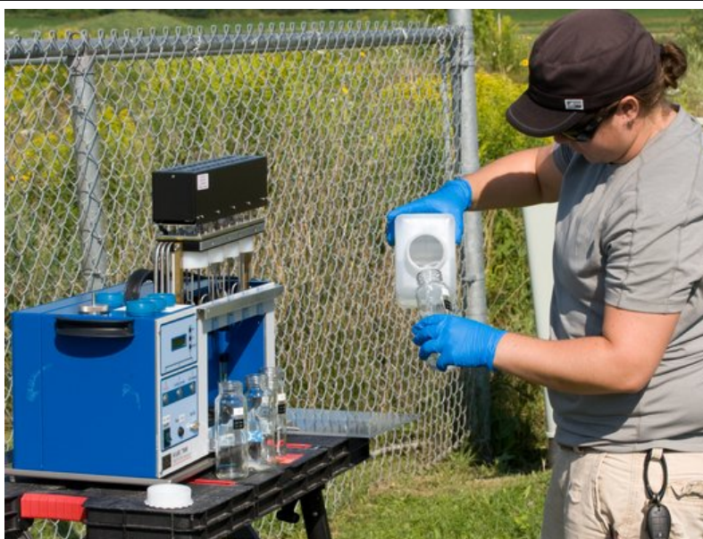
Les employés de la CCSN analysent l'air à l'extérieur de SRB Technologies à Pembroke (Ontario) afin d'y détecter du tritium .
