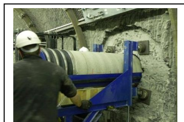
Emplacement du modèle grandeur nature d'un conteneur de déchets dans une cellule d'élimination expérimentale au Laboratoire souterrain de recherche de Tournemire, en France
