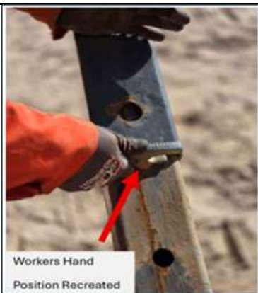
Fig. 4. Reconstitution de la position de la main de la personne blessée sur la poignée de la goupille.
