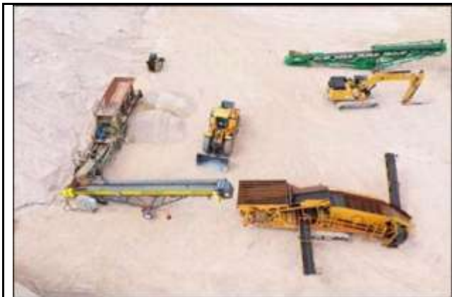
Fig. 1. Photographie aérienne, aux fins de référence, de l'aire de concassage montrant l'aménagement de concassage mobile, l'appareil de gerbage de 60 pieds, le chargeur et l'équipement adjacent.
