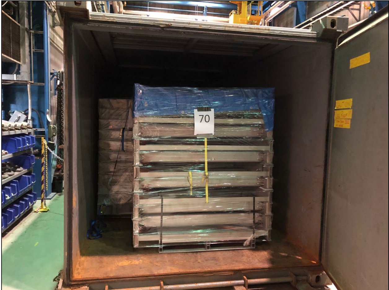
Photo 12 : Emballage de déchets radioactifs solides en vue d'un transport terrestre
