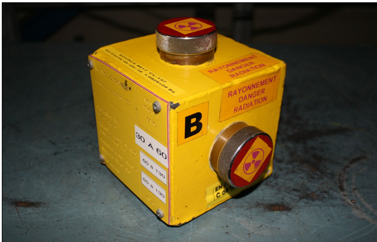
Photo 6 : Bloc-source de vérification d'appareils de détection de rayonnement de Gentilly-2
