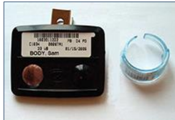
Dosimètre pour le corps entier (à gauche) et dosimètre d'extrémités (à droite).
