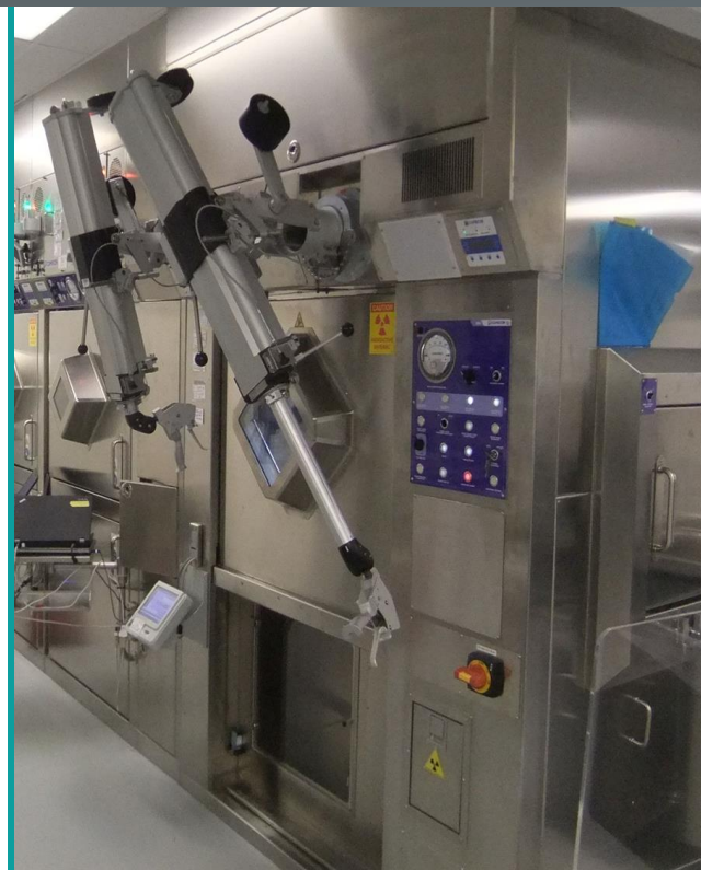
Cellules de haute activité utilisées pour manipuler les substances nucléaires non scellées produites par un cyclotron (source : personnel de la CCSN)
