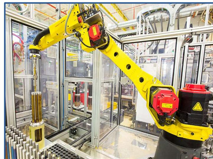
Un robot insère des barres de combustible dans un assemblage de grappes de combustible chez Cameco Fuel Manufacturing
