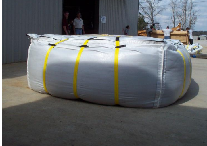
Figure 16: Sols ou déchets en vrac générés par le déclassement
