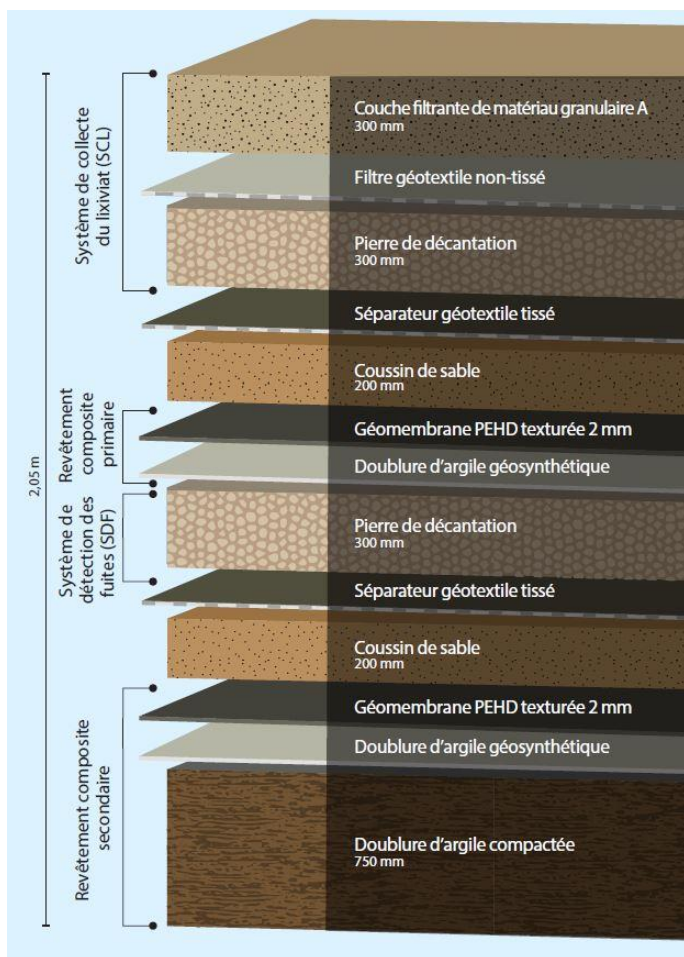
Figure 20: Système du revêtement de base
