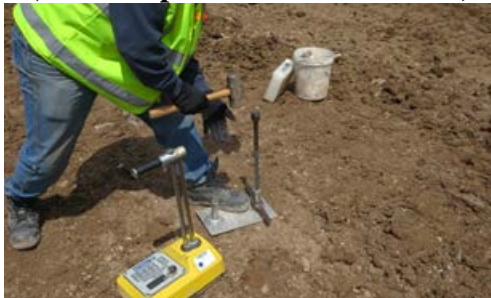
Figure 62 : Travailleur utilisant une jauge portative (Source : personnel de la CCSN)
