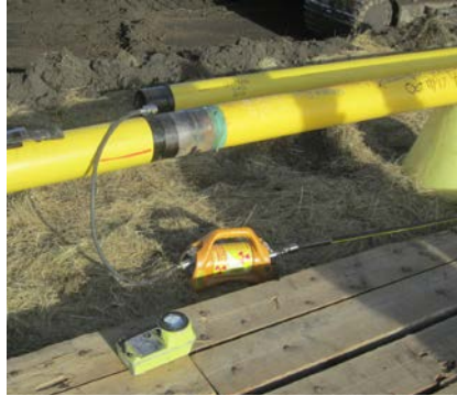
Figure 28 : Appareil d'exposition utilisé pour l'essai non destructif des matériaux (Source : personnel de la CCSN)
