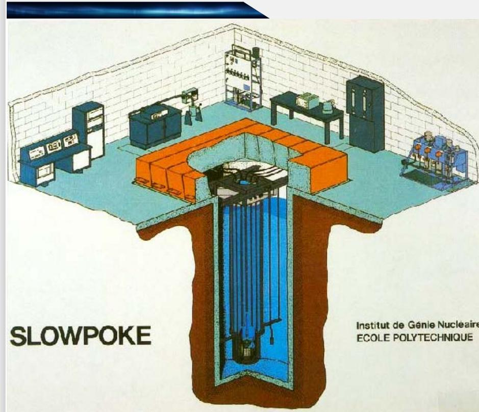
Schématisée du réacteur SLOWPOKE d'École Polytechnique.
