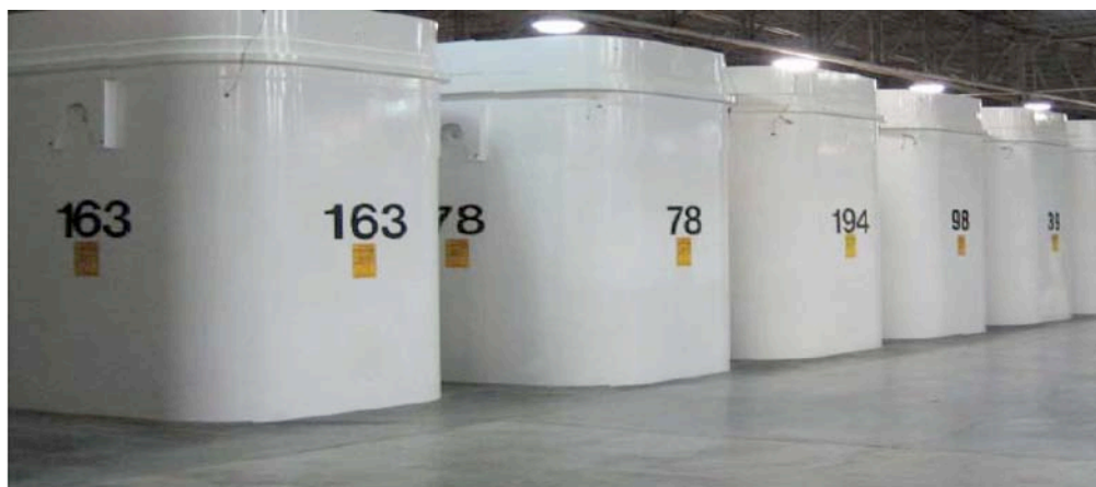
Figure 4.4 — Conteneurs de stockage à sec à l'installation de gestion des déchets Pickering
