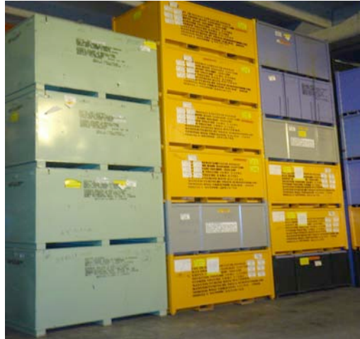
Figure H.1 — Conteneurs de stockage de déchets faiblement et moyennement radioactifs d’OPG à l’Installation de gestion des déchets Western
