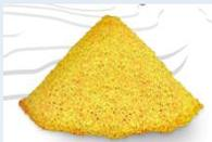
Le minerai est broyé et l'uranium ( $U_3O_8$ ) est séparé chimiquement de la plupart des autres constituants. Le concentré d'uranium, contenant environ 98 % d'uranium (yellowcake) est expédié vers une raffinerie.
