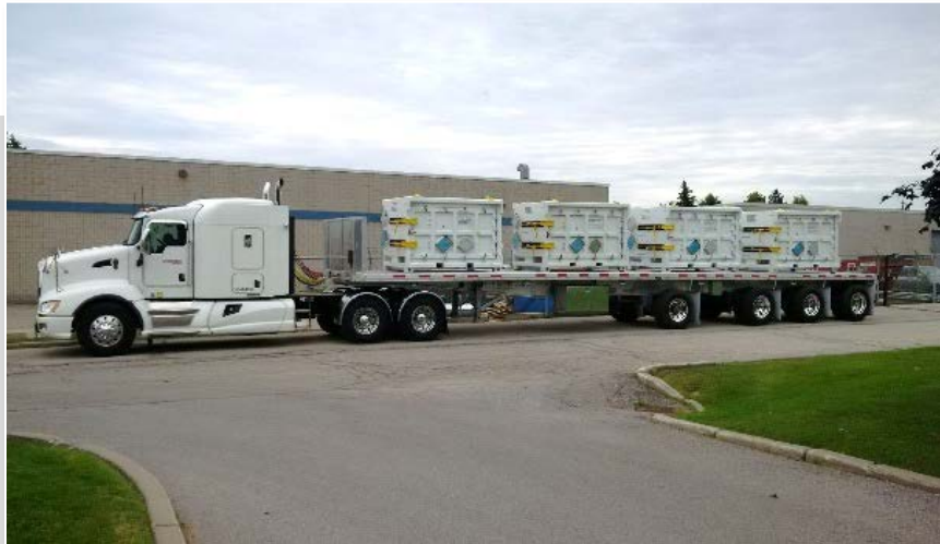
Colis de transport DSTAR contenant des conduites d'alimentation
