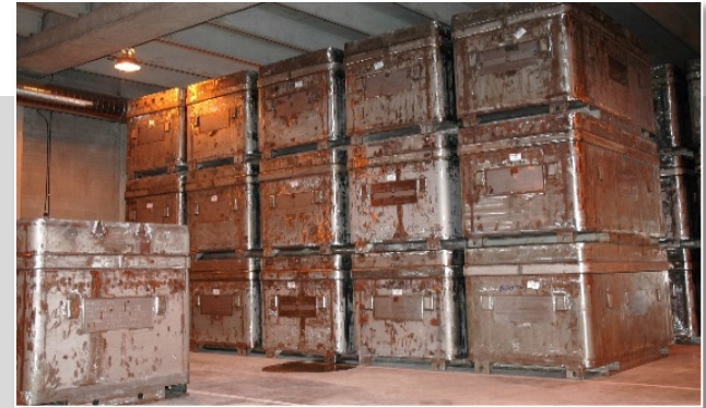
Contenants de déchets de retubage
