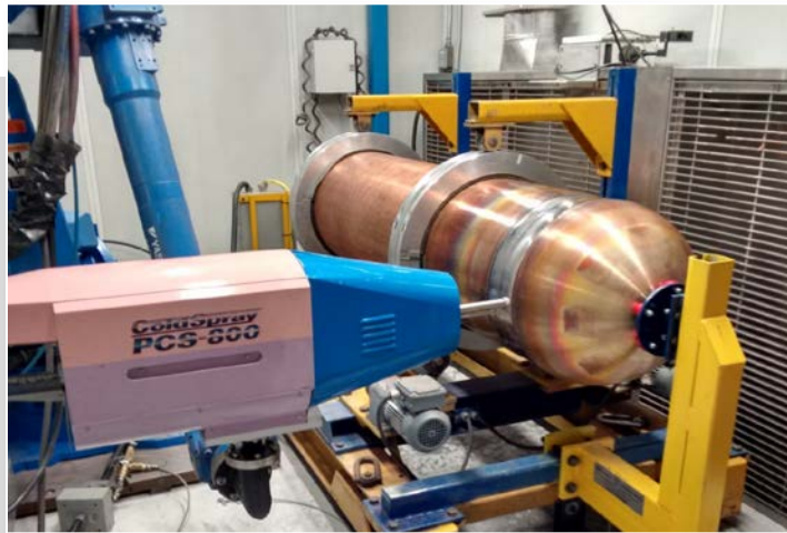
Revêtement de cuivre pulvérisé à froid sur la zone de soudure du couvercle d'un contenant (gracieuseté de la SGDN)
