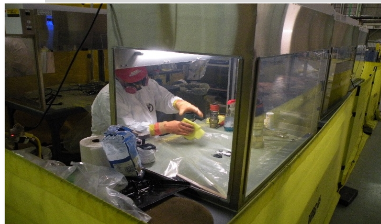
Travailleurs triant des déchets radioactifs afin de les détourner vers des méthodes de réduction du volume ou de les rejeter sans restriction
