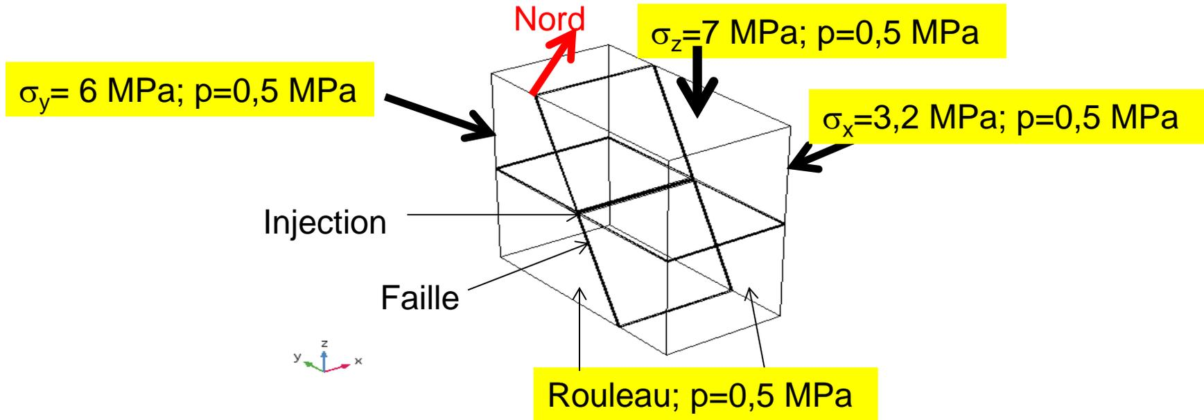
Pendage de faille  $65^\circ$ , direction  $N45^\circ E$
