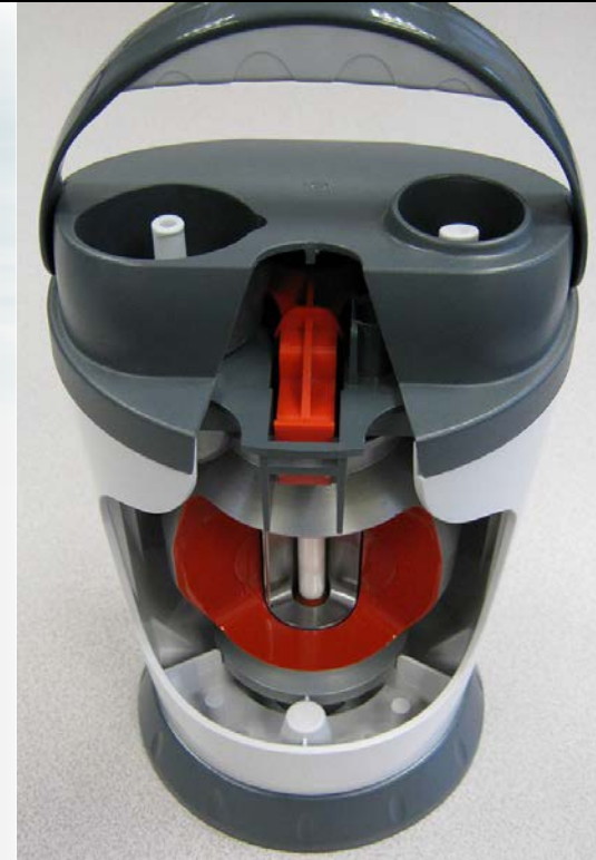
Modèle en coupe d'un générateur au technétium. L'échantillon de molybdène/alumine est placé au centre de l'appareil et entouré de blindage (en rouge).
