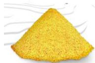
Le minerai d'uranium est broyé, et l'uranium ( $U_3O_8$ ) est séparé chimiquement de la plupart des autres constituants. Le concentré d'uranium, qui contient environ 98 % d'uranium (yellowcake) est expédié vers une raffinerie.
