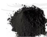
Les contaminants subsistant dans le concentré d'uranium sont séparés chimiquement de l'uranium. L'uranium purifié ( $UO_3$ ) est expédié vers une installation de conversion.
