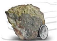
Les roches contenant en moyenne 0,1 à 19 % d'uranium (minerai d'uranium) sont extraites du sol. Le minerai est transporté dans une usine régionale de concentration d'uranium.
