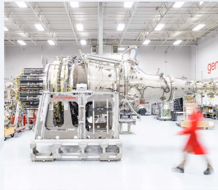
Injecteur de plasma (source : generalfusion.com )
