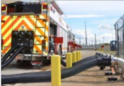
Camions d'incendie de Bruce Power fournissant de l'eau de refroidissement. Nouvel équipement de pompage d'eau d'urgence acquis et présent sur le site.
